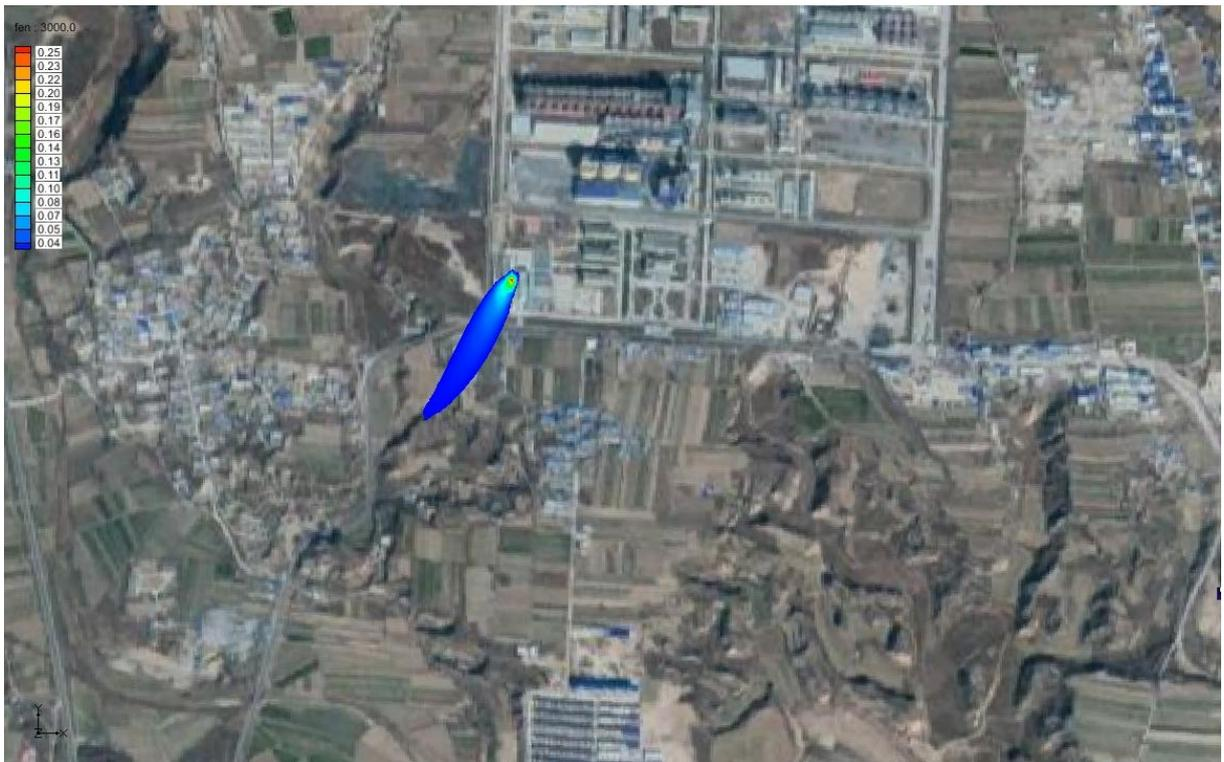
图 5.3-16 氟化物迁移 3000 天污染羽分布图
