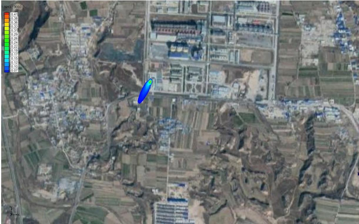
图 5.3-19 氨氮迁移 3000 天污染羽分布图
